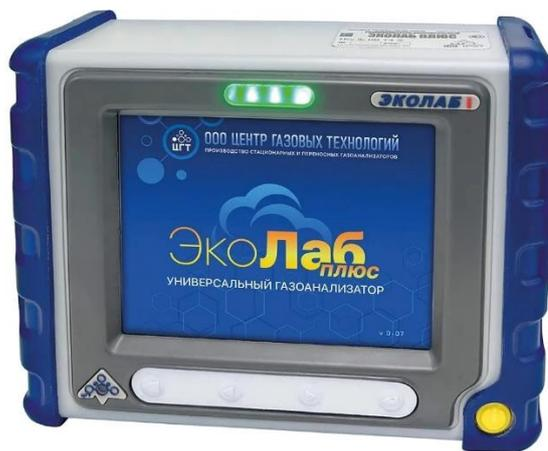
Прибор «ЭКОЛАБ ПЛЮС» предназначен для автоматического измерения концентрации химических веществ в атмосферном воздухе, в воздухе рабочей зоны, бассейнах, в закрытых (замкнутых) и жилых помещениях, в промышленных помещениях и открытых пространствах промышленных объектов, в ventвыбросах, в технологических процессах и в промышленных выбросах в целях санитарно-эпидемиологического благополучия, охраны окружающей среды, охраны труда, промышленной безопасности и оптимизации технологических процессов.
