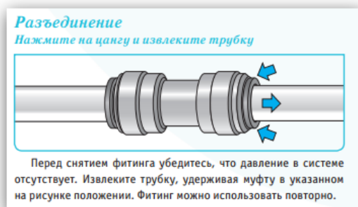
Рисунок 2 – Разъединение трубок от устройства пробоподготовки УП 1/1
