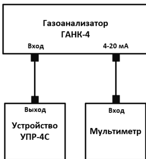
Рисунок А.2 – Схема проверки газоанализатора с принудительным забором пробы
