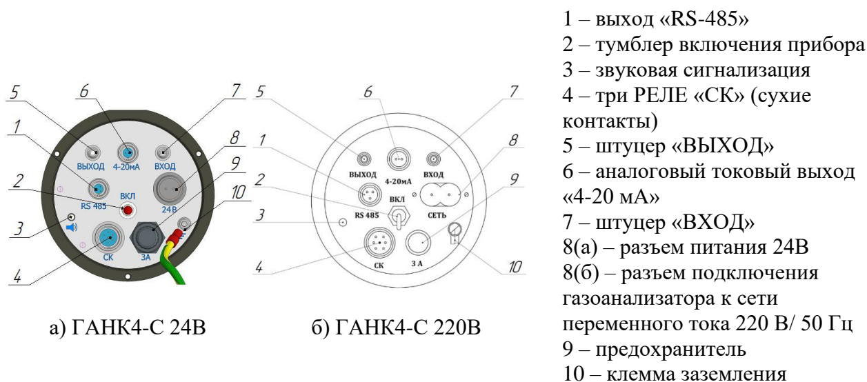
Рисунок 16 – Монтажная панель ГАНК4-С
