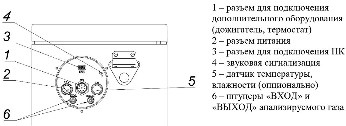
Рисунок 10 – Вид на разъемы
