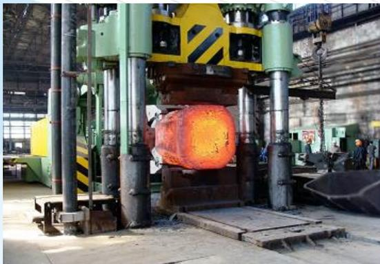
**Кузнечно-прессовый участок и участок мех обработки** - получение штамповочной продукции на молотах, прессах, ковочных машинах из стального слитка. Обработка штампа до готового продукта.
