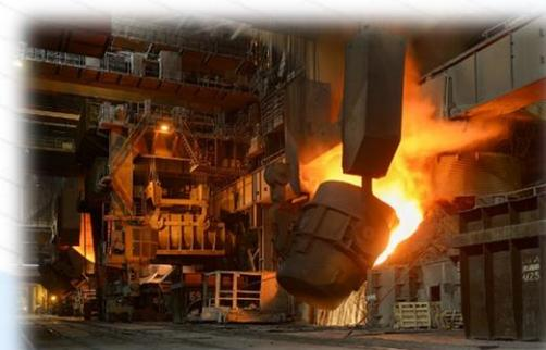
**Конвертор** - получение стали из предельного расплавленного чугуна и шихты продувкой воздуха или технически чистым кислородом
