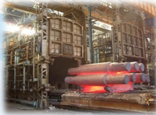
**Участок термообработки** – нагрев металла в ваннах с расплавленными солями, радиальных электропечах, установках ТВЧ, газовых печах нарева, закалочные масляные ванны
