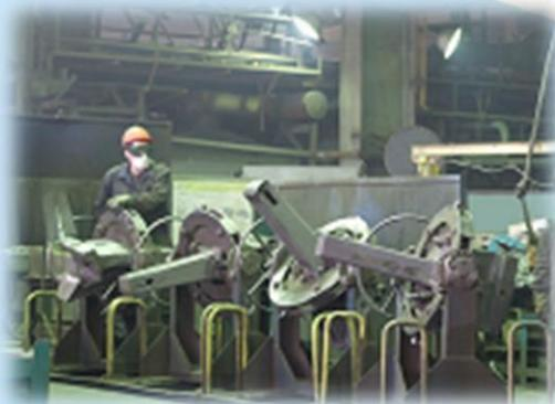
**Обрубной участок** – удаление прибылей, выравнивание поверхности, очистка
