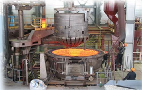
**Участок электрошлакового переплава** – выплавка стали с добавками
