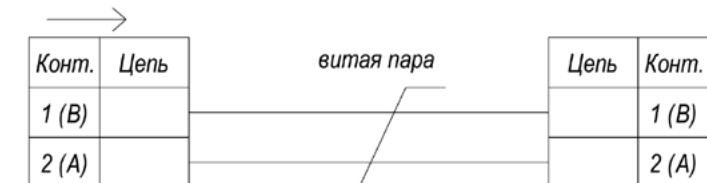
Рисунок Ж7 – Схема электрическая распайки кабеля RS-485
