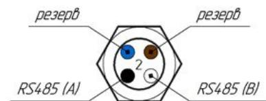
Рисунок 51 – Порядок присоединения кабелей
