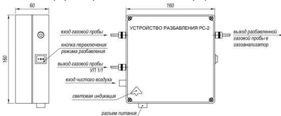
Рисунок 55 – Внешний вид устройства разбавления РС-2
