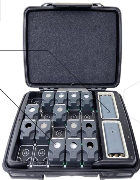
Модуль представляет собой пылевлагозащитный кейс, в корпус которого встроены плата управления, разъёмы для подключения датчиков, отсеки для подключения аккумуляторов, звуковой и световые индикаторы.
